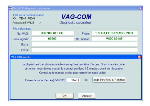
La fonction accès doit être utilisée sur certains calculateurs avant de pouvoir les recoder ou de changer des valeurs d'adaptation. Certains codes d'accès activent ou désactivent directement une fonction comme le régulateur de vitesse. Les codes d'accès valides peuvent être trouvés dans le manuel atelier. Si vous travaillez sur l'antidémarrage, vous aurez à utiliser le bouton **[Code PIN/SKC à 7 chiffres]**. Cette fonction est décrite en page 18.
