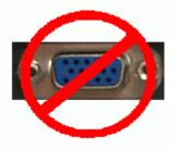
Regardez le port entouré en **vert**. Il a **9 broches mâles**. C'est un port série qui fonctionnera avec VAG-Com. Maintenant regardez le port entouré en **rouge**. Il a **15 broches femelles**. C'est une sortie moniteur, et elle ne marchera **PAS** avec VAG-Com! Un convertisseur USB => RS232 ne marchera pas non plus.
