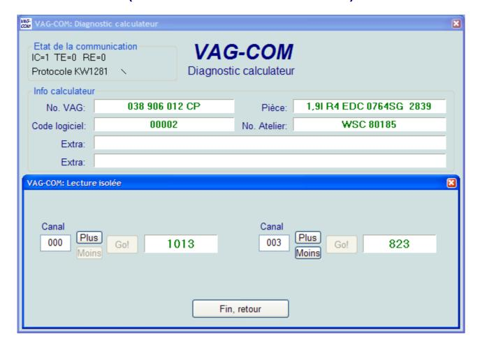
Cette fonction vous permet d'observer des données en provenance des calculateurs (qui la supportent) en temps réel. Toutefois, AUCUNE information quant à la signification des données ainsi envoyées n'est fournie par le calculateur.
