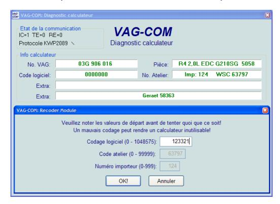
Le recodage est utilisé afin de définir diverses options d'un calculateur.
