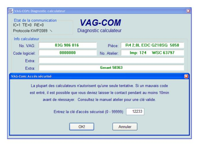
La fonction d'accès sécurisé doit être utilisée sur certains calculateurs KWP2000 avant de pouvoir les recoder ou changer des valeurs d'adaptation. Sur d'autres, elle permet d'activer ou de désactiver certaines fonctionnalités. Vous pourrez trouver les codes d'accès sécurisé, s'ils existent, dans le manuel atelier de votre véhicule.
