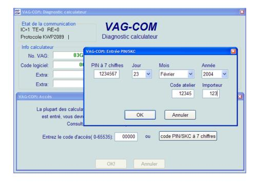
La fenêtre code PIN/SKC à 7 chiffres est utilisée pour l'apprentissage des clés et des immo-3. Les informations suivantes doivent être entrées:
